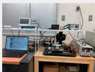
例 2: 小型分光器（蛍光スペクトル測定）に光電子増倍管を組み合わせオシロスコープ（燐光寿命測定構成）を付加
