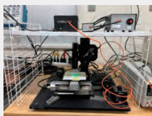
例 2: 小型分光器（蛍光スペクトル測定）に光電子増倍管を組み合わせオシロスコープ（燐光寿命測定構成）を付加
