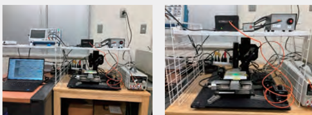
例 2: 小型分光器 (蛍光スペクトル測定) に光電子増倍管を組み合わせオシロスコープ (燐光寿命測定構成) を付加
