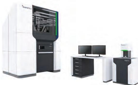
EnviroESCA は試料を準大気圧（最大 0.1 気圧）環境下で測定し、従来のような超高真空環境を必要としません。液体・含水性試料はもちろん、揮発試料や激しく脱ガスする多孔質な試料でも、EnviroESCA の試料室に投入後、僅か数分後には測定を開始します。従来型 XPS では測定を諦めていた試料を分析できるだけでなく、雰囲気ガスや温度を自由に制御して新しい研究分野を開拓する強力な武器となります。現在急速に注目を集めている、デバイス動作環境下での測定、いわゆる“オペランド測定”も簡単に実現できます。
