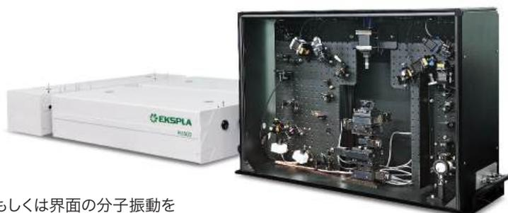
SFG (和周波発生) は二次非線形振動分光法で表面もしくは界面の分子振動を解析 (構造・配向) することができます。
