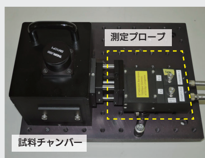
▲ 蛍光寿命ユニットとして 試料チャンバー（オプション）を付属して 専用機として使用できる
