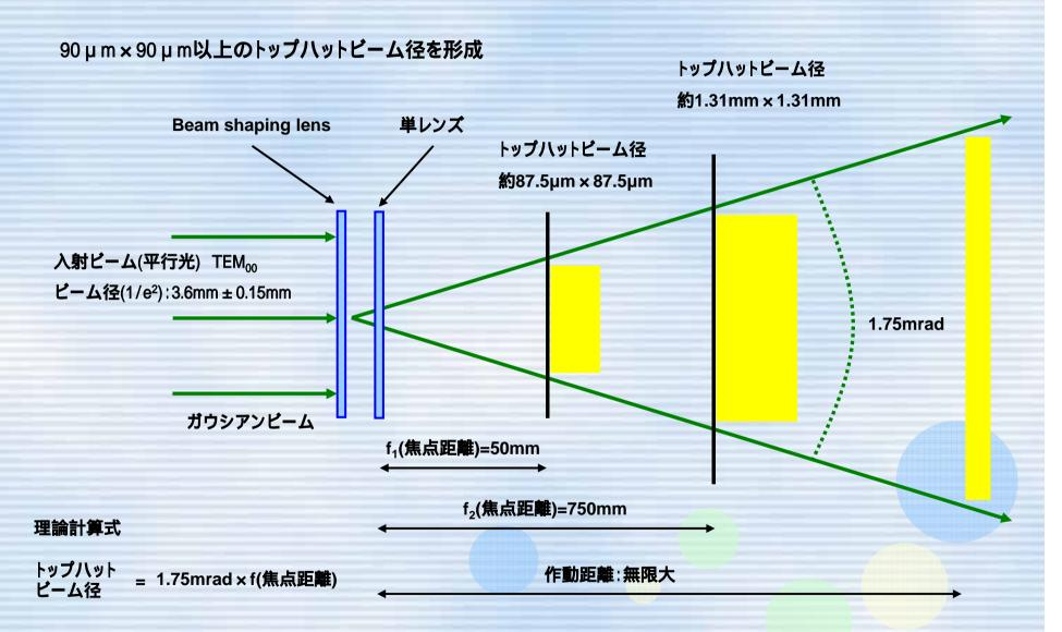
単レンズと組み合わせることで、レンズの焦点面においてトップハットビームを形成します。 また上記の光学配置において、>90μm×90μmのトップハットビーム径を形成します。
