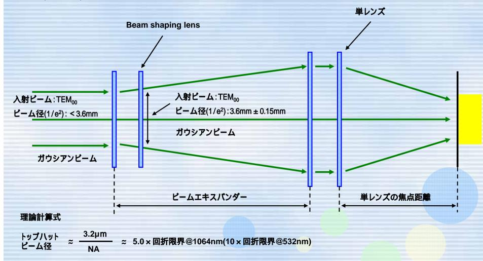
Beam shaping Inesをビームエキスパンダの間に設置した 光学配置においても、<90 µ m × 90 µ mのトップハットビーム径を形成します。
