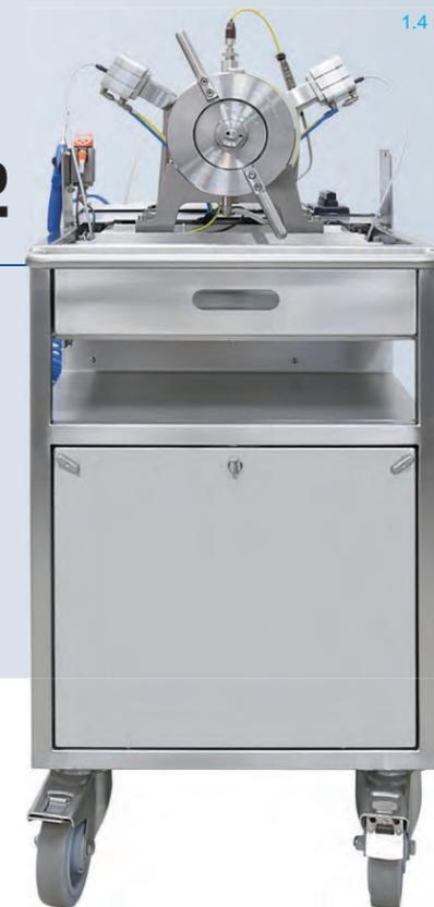
Stojan Vessel を用いた測定は燃焼速度を求めるための高度な手法に基づいています。従来の Strand Burner 法と比較して、Stojan Vessel はシンプルかつ安全な装置であり、1度の測定結果から高度な数学的手法によって弾道特性を導き出すことができます。この手法は、Dr. Petr Stojan によって発明・開発されたもので、この手法は現在チェコ共和国におけるロケット推進薬の標準試験方法として採用されています。
