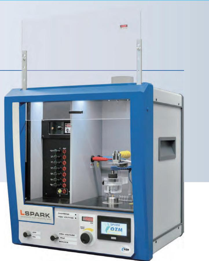
L SPARK™ は、エネルギー物質の試験において比較法を採用しています。すなわち、試験対象の物質の反応を既知の静電気放電（ESD）挙動を持つ基準物質と比較する方法です。L SPARK は、最小限の時間とコストでサンプルが静電気放電にさらされた際のリスクに関する基本的な情報を提供します。この動作原理においては、放電エネルギーの評価や放電の詳細な診断は必要ありません。
