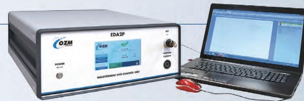
EDA Electro-explosive Devices Analyzer はエネルギー物質や爆発装置に正確に点火し、同時に圧力や温度、発光を高速測定するための測定 / 制御ユニットです。定電流、定電圧、定出カインパルスが発生させるための点火電流値と時間を正確に調整が可能です。また最大圧力、燃焼時間、点火遅延時間、電流及び電圧、圧力勾配、圧力上昇時間、燃焼速度の記録と評価機能を有しています。
