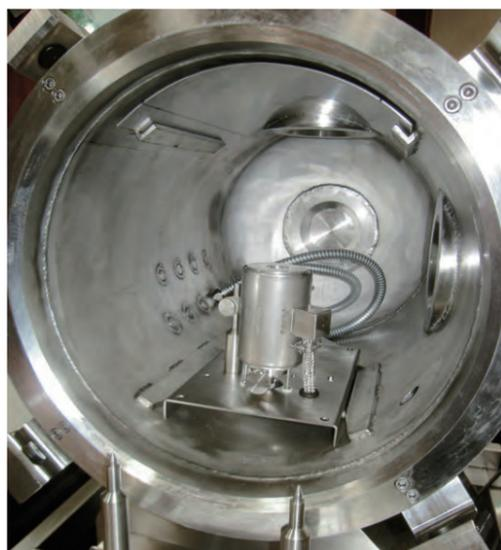
電気加熱ブロック付きのコンテナ内部
