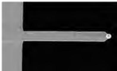
ティップなしのカンチレバーの先端に、ミクロンサイズの球状粒子が固定されているプローブです。粒子の材質はBSGとSiO<sub>2</sub>の2種類、球状粒子の直径は4種類から選択頂けます。
