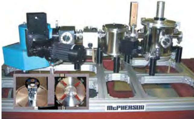
**VACUUM ULTRAVIOLET ANALYTICAL SPECTROPHOTOMETER**
