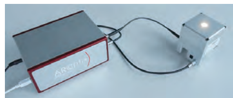
▲ 光源内蔵小型積分球接続 (反射測定システム構成例)
