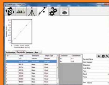
標準キャリブレーション曲線を作成し、未知の元素の定量に簡単・スムーズに適用することができる。
