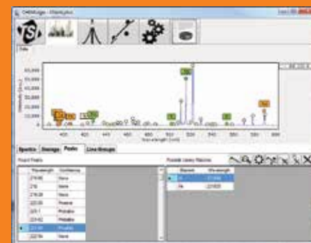
OESスペクトルの元素を自動的に識別し、またはライブラリ登録とスペクトルを一致させ物質を特定する。
