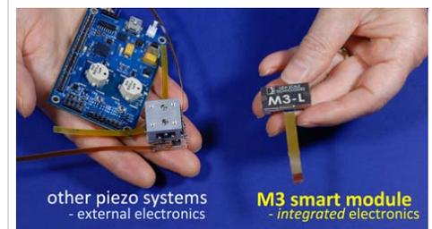
**M3 系列製品の特長：** M3 (micro-mechatronic module) プラットフォームによる弊社製品は小型、高分解能、再現性の高い閉ループ制御、等が特徴です。制御回路内蔵のため、外部回路無しで現用のシステムプロセッサに接続できます。そのため、開発期間短縮に大いに貢献します。
