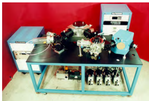
235 型分光器、218 型分光器、 629 ホローカソードランプおよび試料室を 組んだ分光システム
