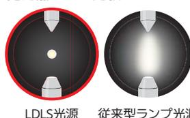
LDLS光源の発光点サイズは微小 $\Phi 0.1$  mmで、従来型ランプ光源よりも高輝度で発光します。
