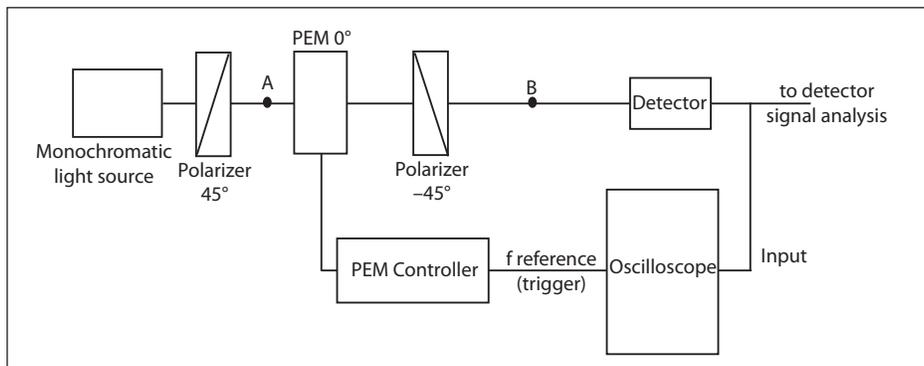
FIGURE 5. OPTICAL BENCH SET-UP FOR  $V_{AC}/V_{AVE}$  CALIBRATION
